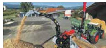
flügel wurden auf der Flügelplatte angebracht, dadurch werden die Hackschnitzel nicht nachzerkleinert. Der Gebläsedeckel kann rasch aufgeschwenkt werden, dadurch können die Verschleißbleche bzw. der Flügel rasch getauscht werden. Zwei große und fünf kleine Zuführschnecken befördern das Hackgut schonend zum Gebläse!
